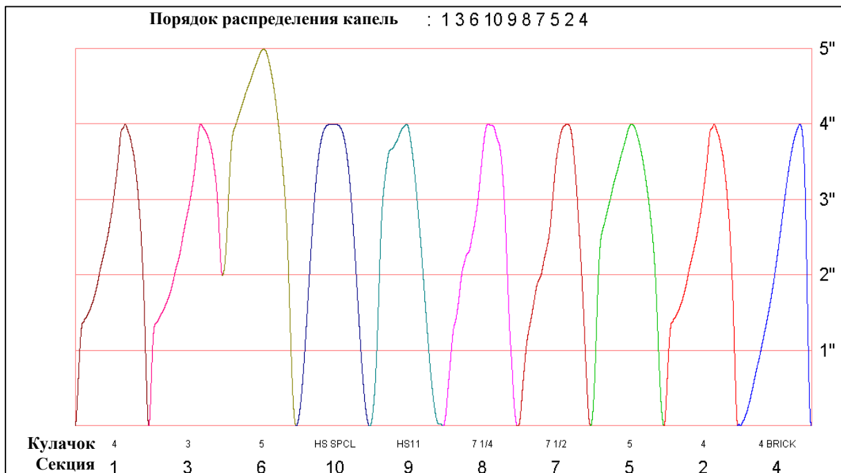
Рисунок 7: Схема расположения кулачков для питателя на 10 секций с объединенными снизу кулачками
