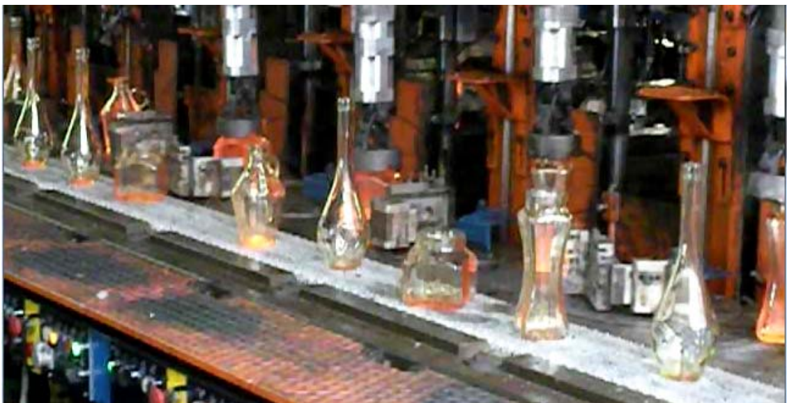
Bild zeigt die Flexibilität mit 4 verschiedenen Behältern (Gewichten) auf einer IS 8 Maschine
