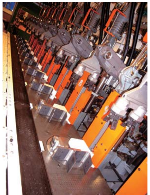
图3 SIS型号的5½双料滴10组行列式制瓶包装机械，装备有26-line阀组（EPVB）和双轴伺服瓶罐推送器（FlexPusher）。
