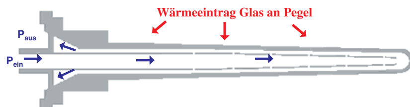
Bild 1: Geometrie und notwendige Randbedingungen des stationären Modells
