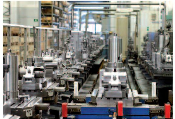
WORK PIECES ARE AUTOMATICALLY FED TO THE MILLING/GRINDING CENTRE FOR ROUND-THE-CLOCK OPERATION
